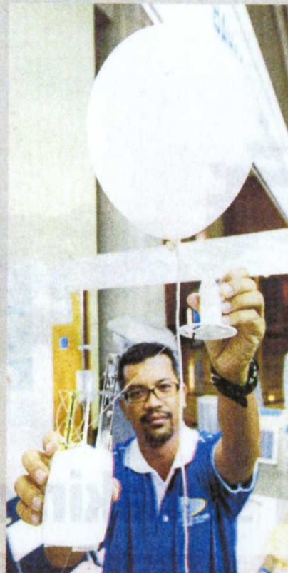
Penolong Pegawai Meteorologi, Abdul Latif Abdul Rahman menunjukkan alat pakai buang Radiosonde yang digunakan untuk mendapatkan maklumat cuaca dan udara.
